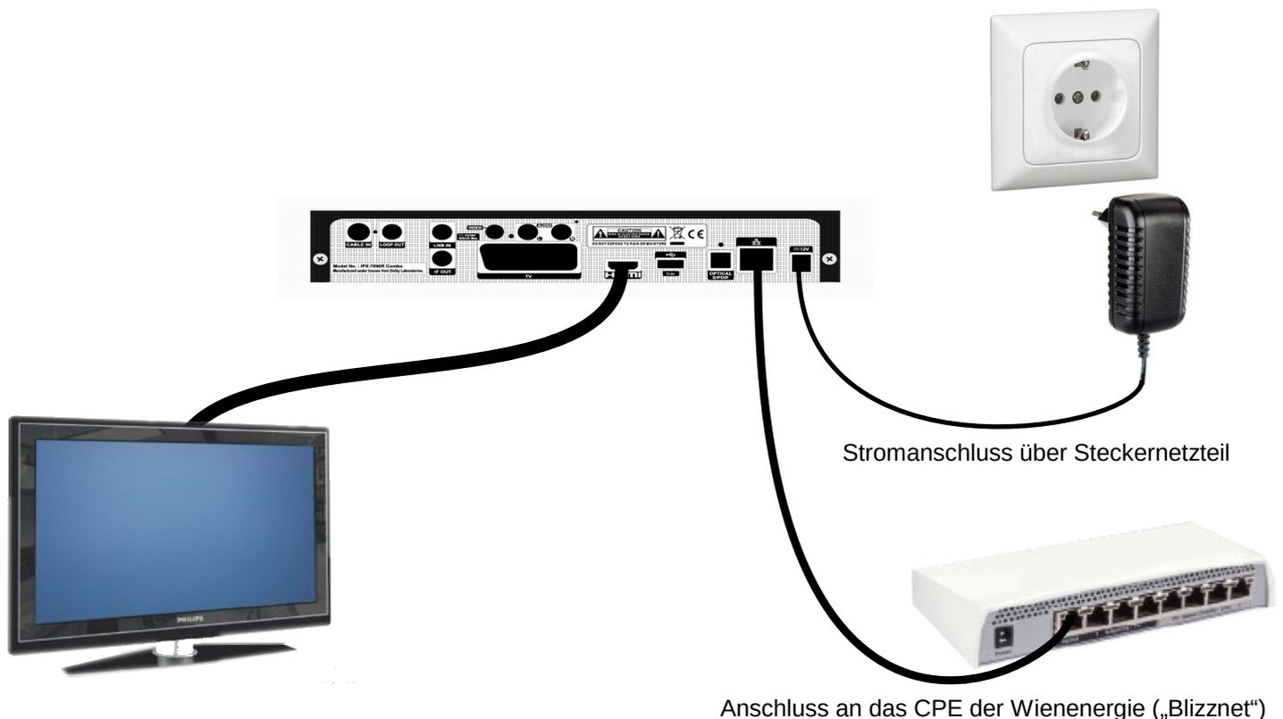
Anschluss an Ihr TV-Gerät, hier am Beispiel eines HDMI-Anschlusses. Für andere Verbindungen lesen Sie bitte im Handbuch der TV-Settopbox nach.
